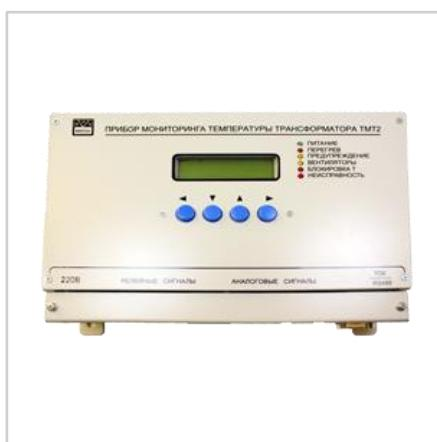
С помощью этого прибора отслеживается функционирование трансформаторов, в которых использован жидкий диэлектрик, например, трансформаторное масло. Он позволяет оперативно контролировать температурные параметры трансформаторов, управлять их системой охлаждения. Также определяет остаточный термический ресурс изоляции и сигнализирует о превышении заданных температурных значений.
