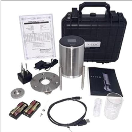
VISCO относится к категории компактных вискозиметров. Работает как от сети, так и от встроенных батарей формата АА.
