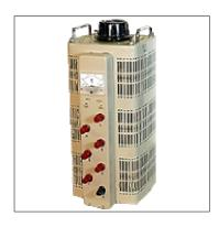
Состоит из трех однофазных автотрансформаторов. На передней панели расположен вольтметр, измеряющий напряжение между фазами АВ. Предназначен для плавного регулирования напряжения от 0-430 в сети 380В.
