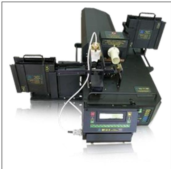
Предназначен для размагничивания и выявления поверхностных дефектов стальных цилиндрических роликов диаметром 34 мм и длиной 55 мм из состава буксовых подшипников № 2536 электровозов.
