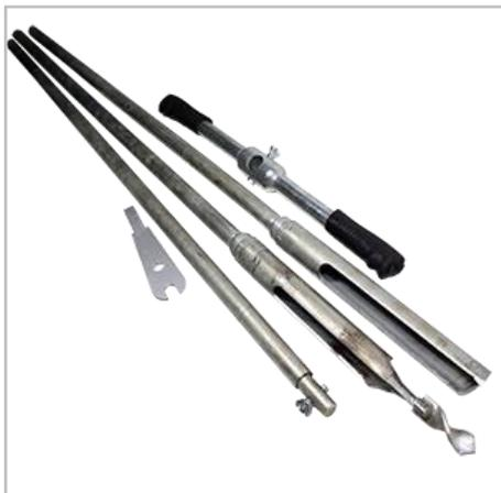
Бур почвенный АМ-26 предназначен для взятия образцов почвы с нарушенной структурой, а так же для определения глубины промерзания почвы и бурения скважин для мерзлотометров.
