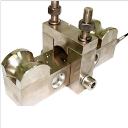
Специализированные датчики консольного (балочного) типа предназначены для измерения силы натяжения троса. Эксплуатация и монтаж датчика осуществляются без разрыва троса. Данная модель датчика особенно востребована в нефтедобывающей промышленности. Серия тензометрических датчиков К-Б-12Т представлена моделями с наибольшим пределом измерений от 1 до 20 тонн.
