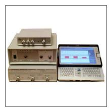
Диагностическая установка «Импульс-10» предназначена для диагностики механического состояния обмоток силовых трансформаторов и шунтирующих реакторов. Выявляемые дефекты - развивающиеся механические повреждения обмоток (деформации, смещения витков, катушек, распрессовка обмоток), а также дефекты магнитной системы (смещения, образование контуров, замыкания листов, замыкания на землю).
