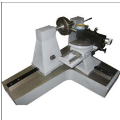
Биенимер «НИИК-1010» предназначен для измерения радиального биения зубчатого венца колес.
