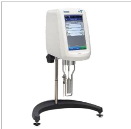
Вискозиметры Брукфильда ротационные DV2T, DV3T предназначены для измерений динамической вязкости жидкостей в лабораторных условиях.
