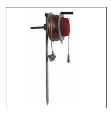
Устройство наброса «УНП-10Б «Бумеранг» предназначено для экстренного заземления воздушных линий посредством короткого замыкания между проводами ВЛ закороткой, соединенной с «землей» во всех случаях требующих моментального отключения воздушных линий для освобождения пострадавшего от действия электрического тока. УНП -10Б и УНП-10 состоят из наброса, имеющего активную часть (рабочая), заземляющей части со струбциной, изолирующего канатика с грузиком и заземлителя ЭЗ-1.
