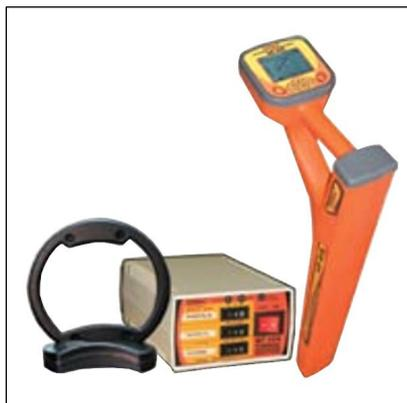
Трассоискатель «Успех АГ-309.20» служит для определения с повышенной точностью местоположения и глубины залегания подземных коммуникаций (силовых и сигнальных кабелей, трубопроводов), а также поиска неисправностей кабельных линий. Трассоискатель позволяет быстро и надежно провести обследование местности перед осуществлением земляных работ и предотвратить повреждение инженерных коммуникаций.
