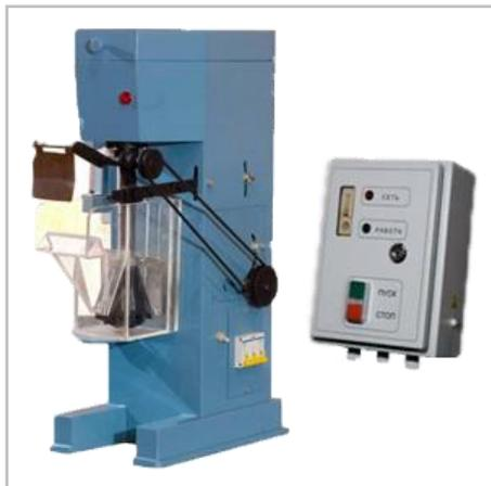
ФМЛ флотационные машины предназначены для лабораторных испытаний руд цветных металлов методом пенной флотации.
