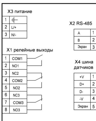
X1 — разъем для подключения внешних устройств приема команд сигнализации.
