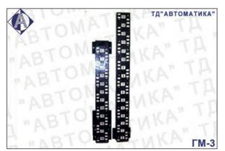
Стационарная водомерная рейка «ГМ-3» представляет собой несколько металлических пластин, закрепленных на металлическом основании (швеллере), имеющих отверстия для размещения вкладышей делений шкалы и ее оцифровки.
