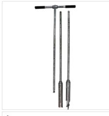
Буры почвенные АМ-16 и АМ-26 предназначены для взятия образцов почвы с нарушенной структурой, а также для определения глубины промерзания почвы и бурения скважин для мерзлотомеров.
