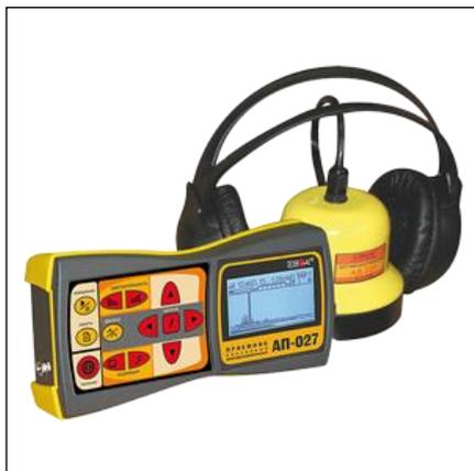
Акустический дефектоискатель Успех-АТ-407Э предназначен для поиска мест повреждений кабельных линий акустическим методом.
