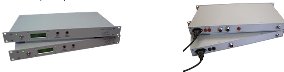
ПИК-М часы первичные (в корпусе 19" высотой 1U)
