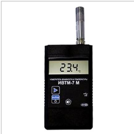
Термогигрометр ИВТМ-7М1 предназначен для непрерывного (круглосуточного) измерения и регистрации относительной влажности и температуры воздуха и/или других неагрессивных газов. Может применяться в различных технологических процессах в промышленности, энергетике, сельском хозяйстве, гидрометеорологии и других отраслях хозяйства.
