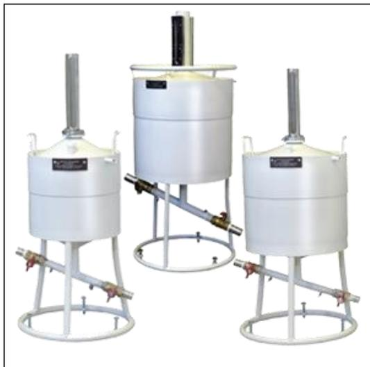
Мерники эталонные 1-го разряда М1Р предназначены для измерения объемного количества жидкостей методом слива и налива.
