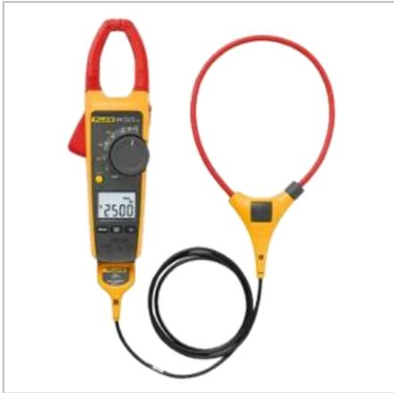
Клещи Fluke-376/FC обладают расширенным функционалом в области измерения тока, например, есть возможность измерения истинного среднеквадратичного значения тока и напряжения. Fluke-376/FC могут отображать значения до 1000А переменного тока и 1000В в режимах как переменного, так и постоянного тока.
