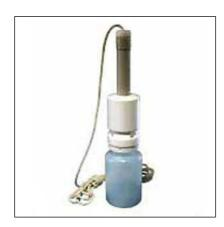
Фторопластовый пробоотборник «ПЭ-1110» предназначен для отбора проб природных и сточных вод из колодцев, водоёмов природного и искусственного происхождения, включая водоемы, покрытые льдом, с глубины 0,3...2,0 м с целью определения в них содержания ультранизких концентраций, загрязняющих веществ. Пробоотборник представляет собой груз во фторопластовой оболочке с отверстиями для воды, в который через переходное кольцо ввинчивается пробоотборная бутыль.
