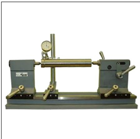
Приборы ПБ-250М, ПБ-500М, ПБ-1600М предназначены для контроля радиального и торцевого биения тел вращения, установленных в центрах.
