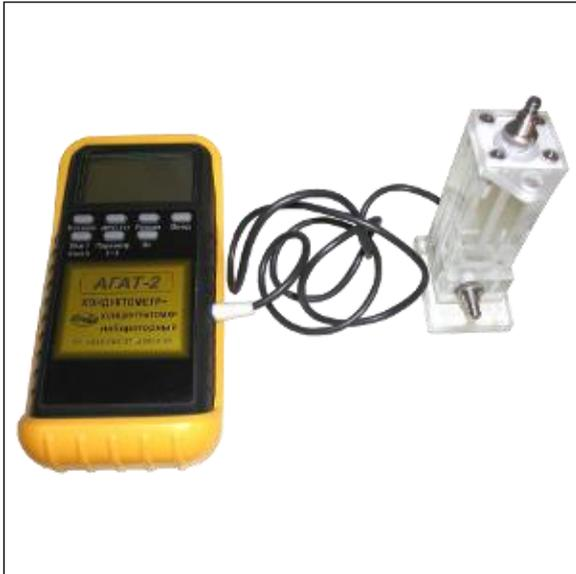
АГАТ-2 - это современный многофункциональный прибор, разработанный на базе хорошо себя зарекомендовавшего лабораторного кондуктометра «ЭКА-2» и предназначенный для измерения удельной электропроводности (УЭП) или условного солесодержания (по NaCl) и автоматического приведения результатов измерения к температуре +25°C.
