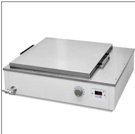
Водяная лабораторная баня с ванной из нержавеющей стали для термостатирования образцов при проведении серологических исследований
