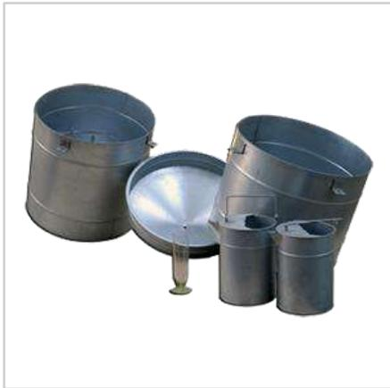
Испаромер-осадкомер ГГИ-3000 предназначен для измерения испарения с открытой водной поверхности. Прибор ГГИ-3000 может быть установлен на плоту в водоеме или закопан в землю.
