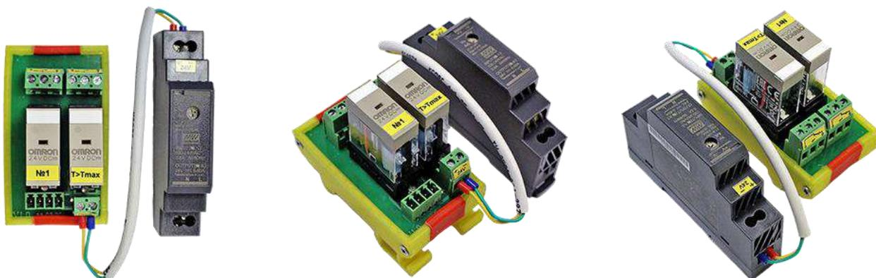
Блок реле для РПЖ-24FT может применяться дополнительно при использовании нескольких РПЖ-24FT в составе электрооборудования. Предназначен для гальванической развязки выходных сигналов РПЖ-24FT и возможности коммутации силовых цепей электрооборудования. Формирует питание для подключаемых РПЖ-24FT. Монтируется на DIN-рейку (возможна установка блока в герметичный корпус).
