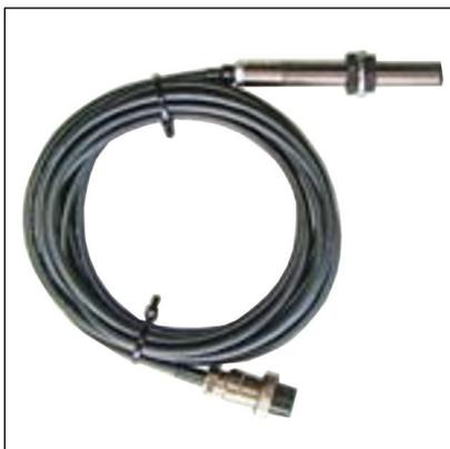
Бесконтактные датчики оборотов (тахометрические преобразователи) **ДВМ-01** формируют импульсы, частота следования которых пропорциональна частоте прохождения тахометрической метки, установленной на элементе (валу) вращающегося объекта, через область чувствительности датчика.
