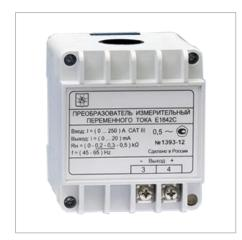
Предназначены для линейного преобразования переменного тока частотой 50 Гц в унифицированный выходной сигнал постоянного тока и могут применяться для контроля токов электрических систем и установок с номинальным напряжением 660В. Отличительной особенностью Е1842 является проходная конструкция, не требующая электрических присоединений к измеряемым цепям.
