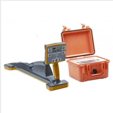
Комплекс предназначен для определения планового положения и глубины залегания коммуникаций, обследования участков местности перед проведением земляных работ.
