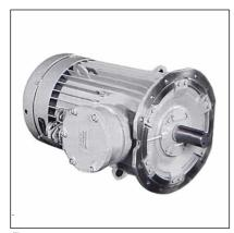
Электродвигатель взрывобезопасный трехфазный асинхронный с короткозамкнутым ротором типа **ЭДКОФВ315** предназначен для привода скребковых и ленточных конвейеров, выемочных агрегатов, проходческих комбайнов и других механизмов в шахтах, опасных по содержанию рудничного газа (метана) и угольной пыли.
