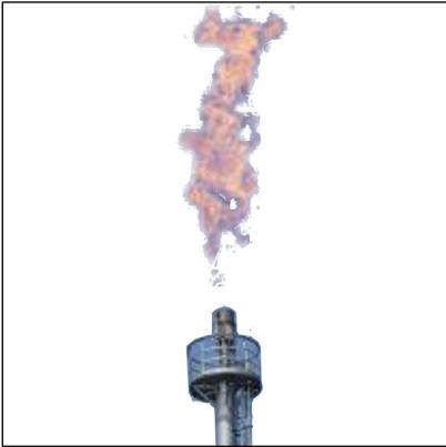
Блок запальных штанг **БЗШ-2** предназначен для дистанционного электроискрового розжига горючих газов в составе факельных установок для сжигания газов при дегазации нефти.
