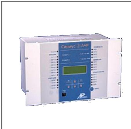
Устройство автоматической частотной разгрузки «Сириус-2-АЧР» предназначено для использования на электростанциях и подстанциях энергосистем с целью ликвидации дефицита активной мощности путем автоматического отключения потребителей при снижении частоты (АЧР) с последующим автоматическим повторным включением отключенных потребителей при восстановлении частоты (ЧАПВ).
