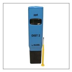
Портативный кондуктометр с встроенным электродом для определения солесодержание и определение на общую минерализацию в воде и растворах для контроля за качеством воды в процессах водообработки, экологических исследованиях, бассейнах и т. д. С ручной калибровкой по 1 точке и автоматической термокомпенсацией.
