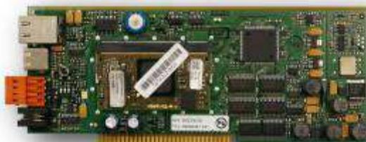
АВ 1.5.0 — модуль сетевого процессора с функциями первичных часов. Предоставляет различные службы, использующие стек протоколов TCP/IP в сетях Ethernet 10/100Base-T: синхронизация с использованием протокола NTP, сообщения об ошибках с помощью SNMP-откликов или электронной почты. Позволяет настраивать параметры модуля при помощи Telnet- или SSH-подключения. Разъем 8P8C (RJ45).
