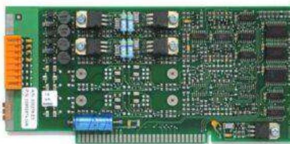
Модули импульсные АВ 4.0.0 и АВ 4.0.1 предназначены для управления с помощью импульсов чередующейся полярности вторичными стрелочными импульсными и цифровыми часами по двухпроводной линии.
