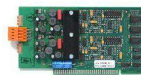
Модуль MobaLine АВ 4.3.0 предназначен для управления и синхронизации стрелочных самоустанавливающихся и цифровых часов, синхронизации компьютеров и микропроцессорных устройств, а также для управления исполнительными устройствами (при подключении адресуемых реле KR462/KR465) по двухпроводной линии.
