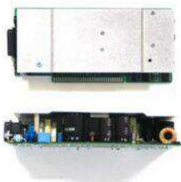
Модули источников питания АВ 5.0.0 и АВ 5.0.1 предназначены для обеспечения сетевого питания часовой станции и зарядки аккумуляторов модуля источника резервного питания АВ 2.0.8.
