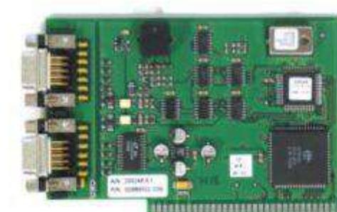
Модуль последовательных портов АВ 4.1.0 предназначен для передачи информационных сообщений (сигналов времени) в соответствии со стандартом RS232/RS422.
