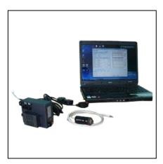
Монитор МД-1 предназначен для осуществления мониторинга непрерывного наблюдения за работой электродвигателя, регистрации режимов и событий, накопления статистических данных о работе электродвигателей и агрегатов на их основе.
