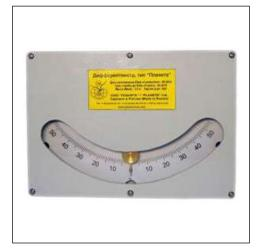
Дифферентометр предназначен для измерения дифферента корабля (судна). Может использоваться как кренометр.
