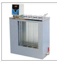
Термостат жидкостный **LOIP LT-810** предназначен для термостатирования стеклянных цилиндров при определении плотности, в том числе при контроле качества нефтепродуктов по ГОСТ Р ИСО 3675-2007, FOCT 3900-85, FOCT P 51069-97.
