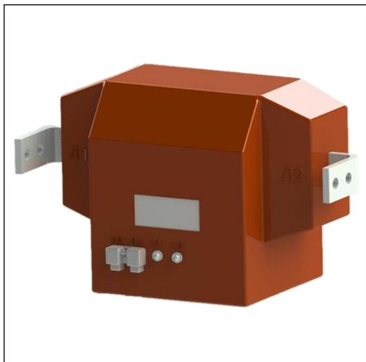
Трансформаторы тока ТПЛ-10 однофазные, по принципу конструкции являются опорно-проходными, с литой изоляцией. Трансформатор может содержать до 4-х вторичных обмоток, каждая из которых расположена на своем магнитопроводе. Выводы первичной обмотки расположены на боковых поверхностях трансформатора. Выводы вторичных обмоток расположены в нижней части литого блока.
