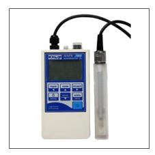
Портативный анализатор растворенного кислорода «МАРК-303Т» предназначен для измерения концентрации растворенного кислорода (КРК) и температуры водных сред, в том числе деаэрированных.
