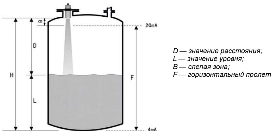
**Рис. 1. Принцип измерения**
