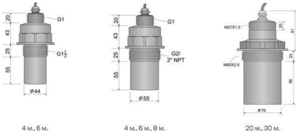
**Рис. 2. Габаритный чертеж**
